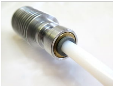
3mm PTFE Tubing Inserted.
